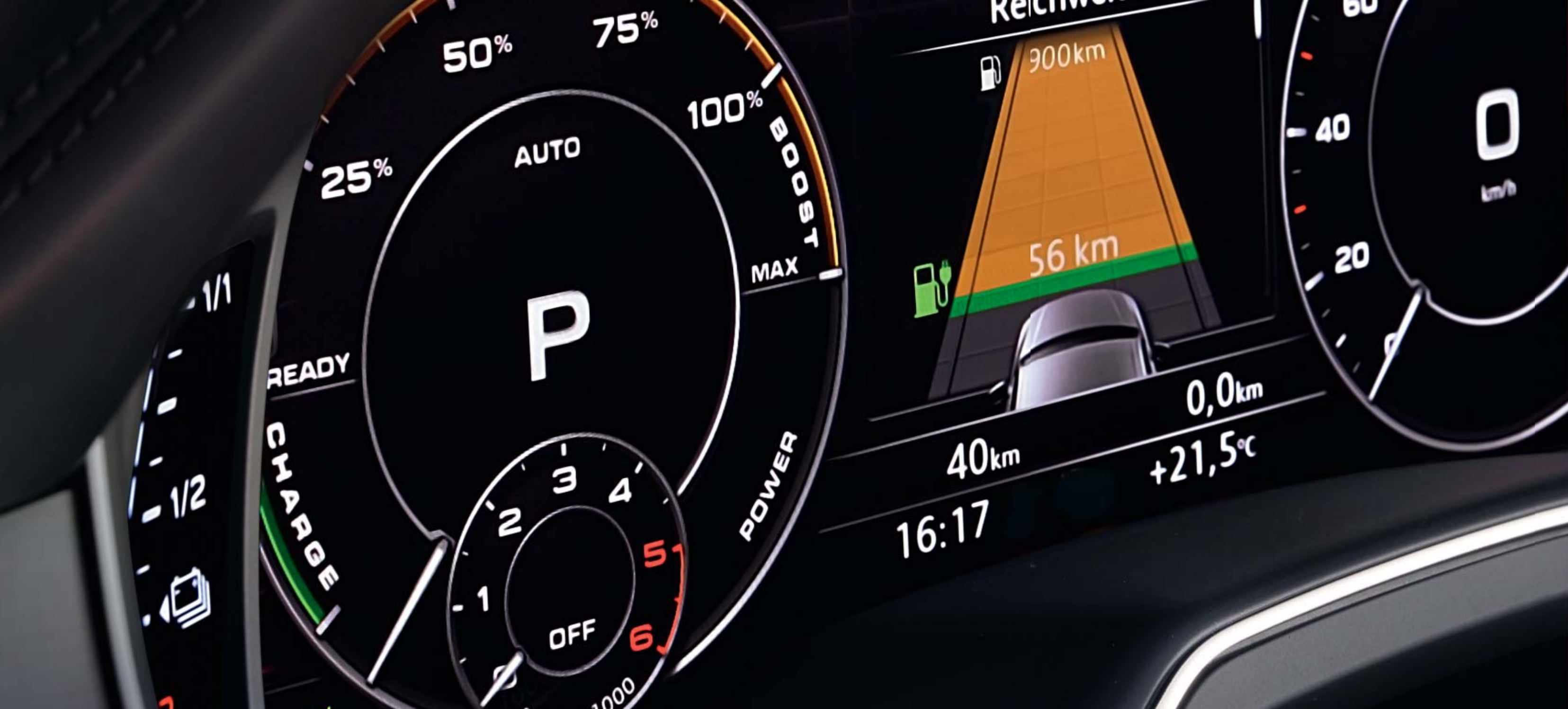
O1_Audi virtual cockpit en la vista clásica con cuentarrevoluciones e indicación de consumo de los últimos trayectos O2_Audi virtual cockpit con mapa de navegación e instrumentos.
